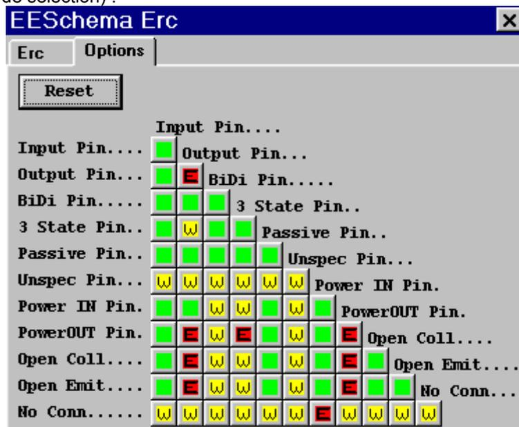
Pour chaque cas de connexion sur la matrice de définition des erreurs, on peut définir une connexion comme « normale », « warning » ou « errreur), en cliquant une ou plusieurs fois sur le bouton correspondant au cas particulier de connexion.
