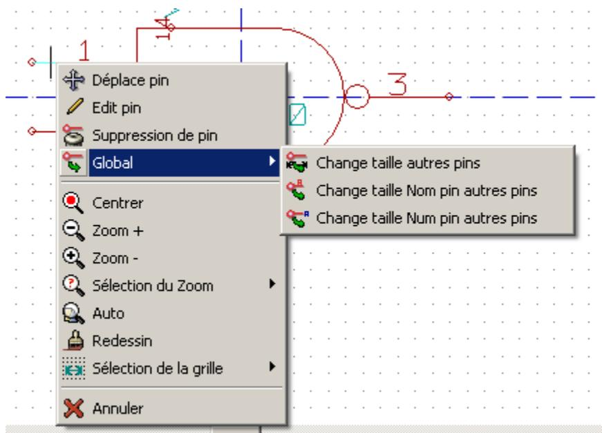
La création des pins doit être soigneusement faite, et est critique, car toute erreur aura des conséquences pour la réalisation de circuits imprimés, ou rendra inopérante la fonction E.R.C. Toute pin déjà placée peut être rééditée effacée ou déplacée.
