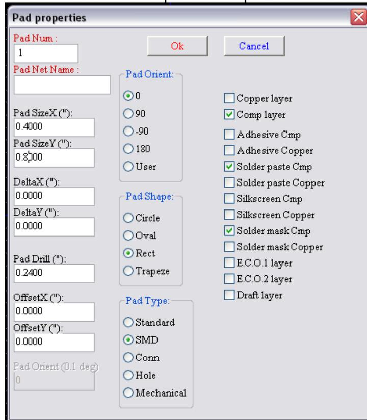
195. Réglez "Pad Num" à "1", "Pad Size X" à "0.4", "Pad Size Y" à "0.8", "Pad Shape" à "Rect" et "Pad Type" à "SMD". Cliquez sur "Ok".
