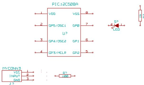
73. En dessous de l'étiquette “MYCONN3” l'identifiant “J?” du composant apparaît. Faites un clic droit sur ce “J?” et cliquez sur “move field”. Déplacer l'étiquette “J?” sous les pattes du composant.
